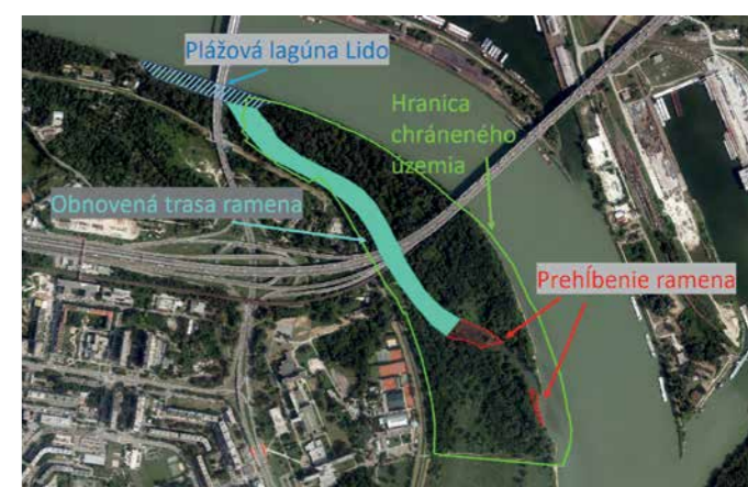
Obr. 32. Navrhnutá obnova Ovsíšťského ramena v chránenom území Soví les na podklade ortofotomapy z roku 2018
